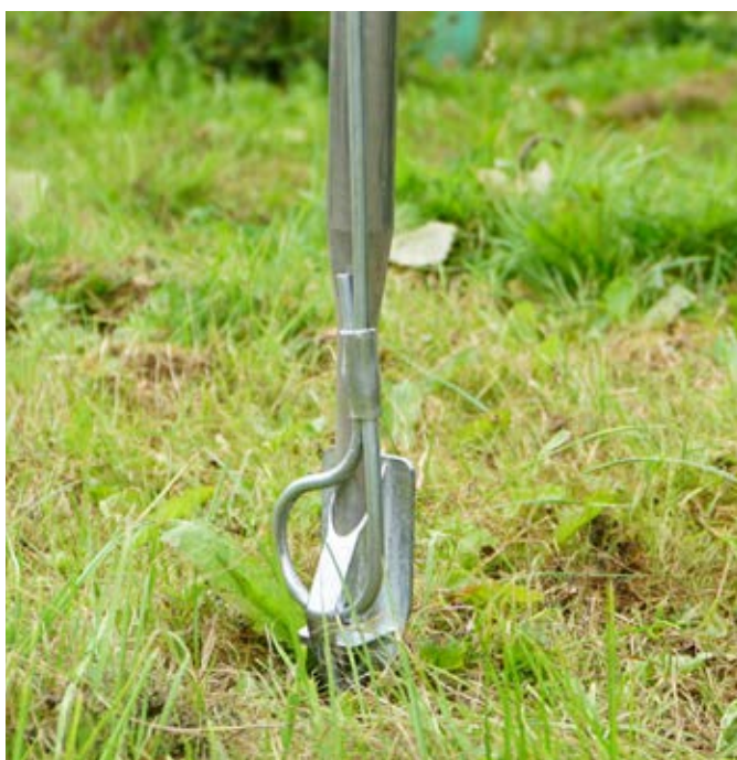
APEX 3 Tirante a barra durante il fissaggio a terra
